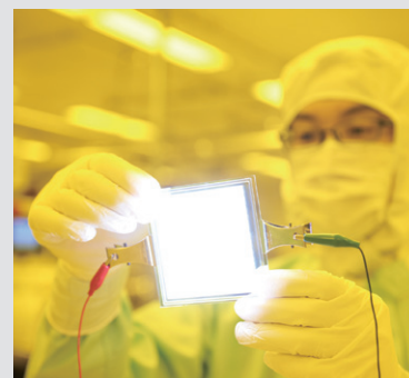
先端材料開発研究所 高分子有機 EL のデバイス試作評価
